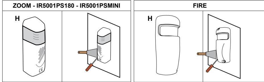
Protezione in pressofusione di alluminio disponibile per serie FIRE / Anti-vandal protection available for FIRE version / Disponible protection antivandale en aluminium pour photocellules FIRE
